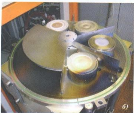
Рис. 1. Установка магнетронного распыления TETRA SCR-650: а) внешний вид установки, б) вид карусели мишеней
