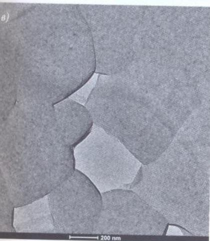
Рис. 7. Контроль качества отдельных слоев методом просвечивающей электронной микроскопии: а) внешний вид просвечивающего электронного микроскопа TECNAI, б) и в) изображения поверхности пленки FeMn, полученные с разным увеличением
